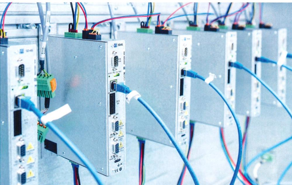
Seit über 20 Jahren arbeitet ein Spezialist für Schraubtechnik mit einem Unternehmen für Antriebs- und Steuerungslösungen zusammen. Sichtbares Zeichen der guten Zusammenarbeit ist unter anderem ein Servoverstärker, der gemeinsam mit einer Prozesssteuerung für hohe Dynamik, guten Gleichlauf und punktgenaue Abschaltung sorgt.
