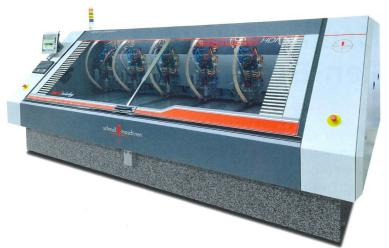
Der zentrale Frequenzumrichter muss in den Leiterplatten-Bohrmaschinen bis zu acht Hochgeschwindigkeitsspindeln im Drehzahlbereich bis zu 480000 1/min sensorlos betreiben können
