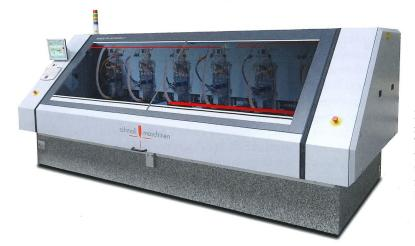
In den Leiterplatten-Bohrmaschinen, die mit T180- bzw. T200-Asynchronspindeln ausgerüstet sind, verbaut Schmoll einen individuell angepassten Frequenzumrichter des Lüneburger Herstellers Sieb & Meyer
