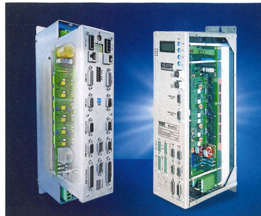
Der SD2 für EST ist ein kundenspezifisches Gerät, das sich vom Standard unter anderem dadurch unterscheidet, dass es ohne Prozessorkarte geliefert wird.
