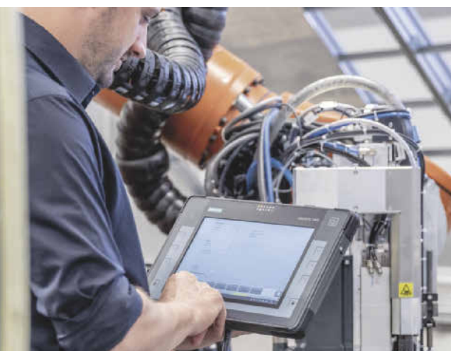
Das robotergestützte Schraubsystem RSF von Weber ist für fließlochformende Verschraubungen konzipiert
