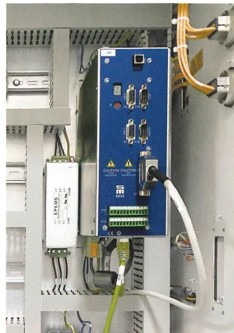
► In einigen Modellen des roboter-gestützten Schraubsystems RSF treibt der Servoverstärker SD2S den Motor der Schraubspindel an.
