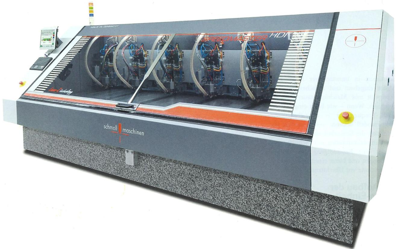
**Bild 1** In den Leiterplatten-Bohrmaschinen, die mit T180- bzw. T200-Asynchronspindeln ausgerüstet sind, verbaut Schmoll einen individuell angepassten Frequenzumrichter des Lüneburger Herstellers Sieb & Meyer. Der zentrale Frequenzumrichter muss in den Leiterplatten-Bohrmaschinen bis zu acht Hochgeschwindigkeitsspindeln im Drehzahlbereich bis zu 480 000 min<sup>-1</sup> sensorlos betreiben können. (Bild: Schmoll Maschinen)
