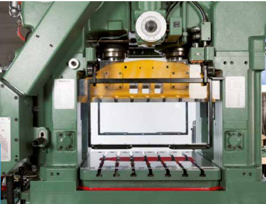
Alte Stanzmaschinen von Bruderer bekommen von Systeme + Steuerungen ein Retrofit.
