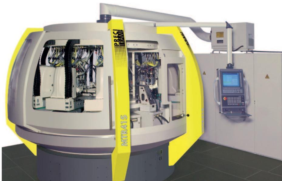
Der individuell angepasste Frequenzumrichter von Sieb & Meyer treibt in den Rundtaktmaschinen von Precitrame die bis zu 54 Haupt-Bearbeitungsspindeln an.
