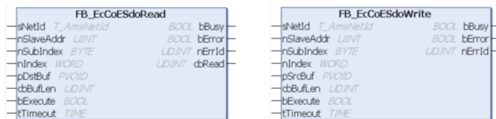
Abb. 27: Funktionsbausteine zum Lesen und Schreiben der SDOs
