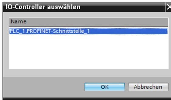
5. Wählen Sie in dem Fenster die PROFINET-Schnittstelle aus und klicken Sie auf „O-K“. Das Gateway wird nun mit dem IO-Controller verbunden.
