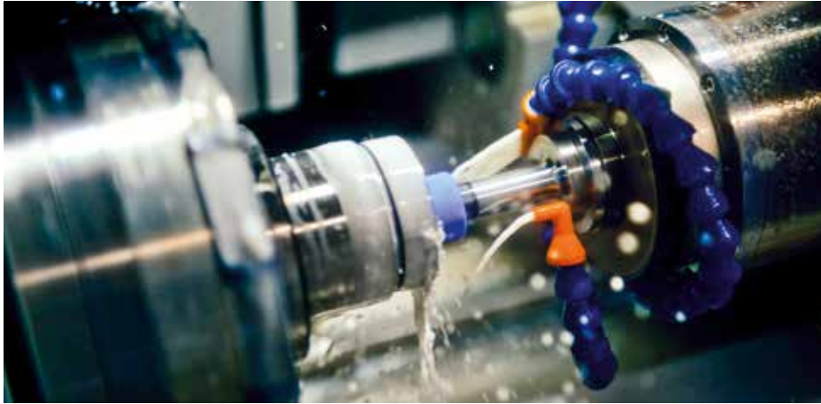
Seine exzellenten Eigenschaften im Betrieb von Hochgeschwindigkeits-Spindeln stellt der SD2S z.B. im Bereich des Innenrundscheifens unter Beweis.
