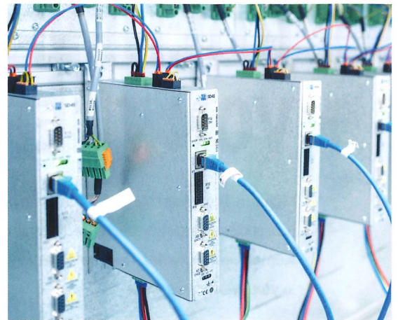
Die SD4x-Geräte ermöglichen den optimalen Betrieb von IPM-Motoren. Bilder: Sieb & Meyer AG
